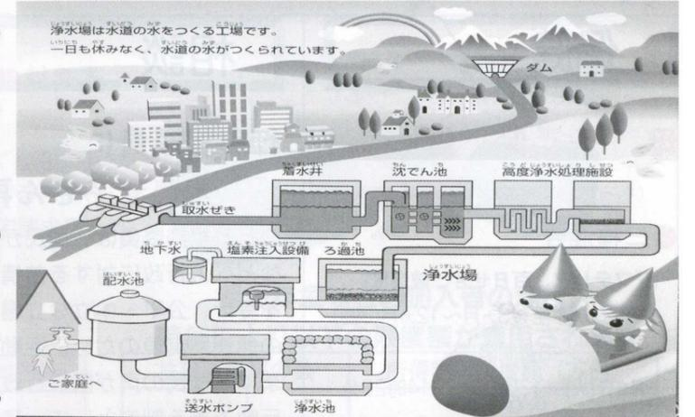
水道の水源地は大きく分けると、川の水、ダムにためた水、地下水の三つになります。それらの水を飲み水にするために浄水場へ運びます。浄水場へ入った水は、まず、水中の小さなごみや砂を取るための薬の働きで沈みやすいたまりにします。水の中の沈みやすくなったごみや砂は沈んで取りのぞかれます。また、高度浄水処理施設のある浄水場では、カビ臭等を取りのぞきます。次に、もっと細かいごみやばい菌を取りのぞくため、ろ過地でしきつめられた砂の間に通して、きれいにします。さらに安心して飲める水にするため、塩素という薬品で消毒します。
