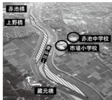
↑洪水時に浸水する河川敷を約13万㎡にわたって掘削し、河川の流下能力を高める工事です。
