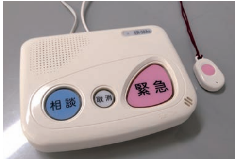
▲緊急連絡装置
