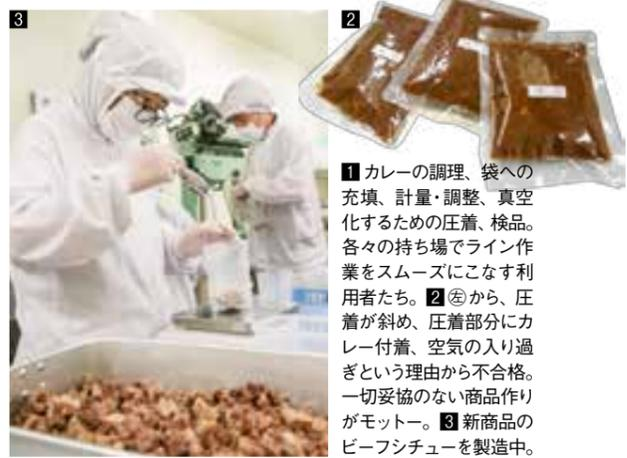
1 カレーの調理、袋への充填、計量・調整、真空化するための圧着、検品。各々の持ち場でライン作業をスムーズにこなす利用者たち。2 ②から、圧着が斜め、圧着部分にカレー付着、空気の入りが過ぎという理由から不合格。一切妥協のない商品作りがモットー。3 新商品のビーフシチューを製造中。
