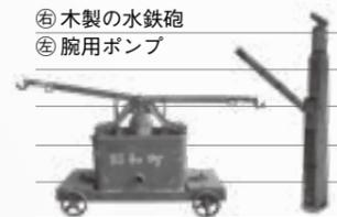
昔は人力で動かす道具が主流だった江戸時代から使われていた「水鉄砲」。一人で持ち運びが可能な筒型の消火器具で、水は細く延びたノズルから噴射されました。「腕用ポンプ」は2人以上でシーソーのように動かしポンプで水を吸い上げ噴射。昭和町と書いていることから、赤池地区の昭和町で使われていたと考えられます。
