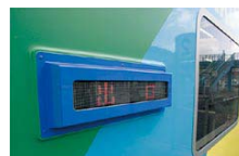
↑出入口付近にある側面の行先表示器は、明るく見やすいLED式。
