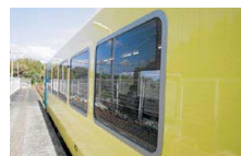
↑防音の効果を上げるために、側窓はすべて一枚ガラスの密閉式に。
