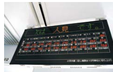
↑運賃や次の行き先が一目でわかる電光掲示板も認識しやすいLED式。
