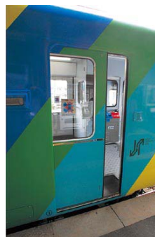
↑鉄道方式の圧迫感の少ないスライドドアで、安全面の向上にも配慮。
