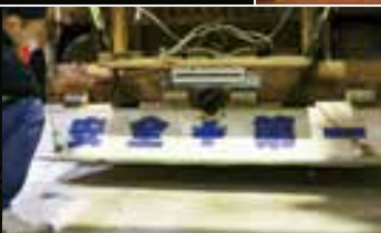
↑過去の事故を教訓に、今では多くの山笠の下部には巻き込み防止の板が取り付けられている。
